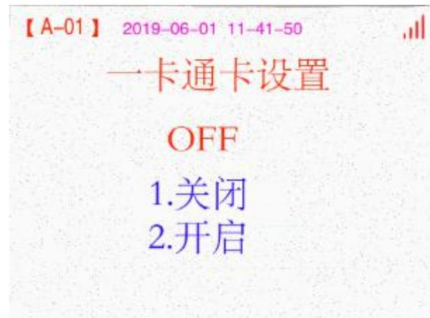
说明：写入 IC 卡设置开启后，在用 IC 卡测试时，测试介绍需要把 IC 卡放到刷卡区，测试成绩会写入 IC 卡中，同时设备主机也有存储，写入成绩的 IC 卡可以到采集端用读卡器把成绩读取出来。一卡通设置开启后可以读取校园一卡通的物理 ID 号进行测试。
