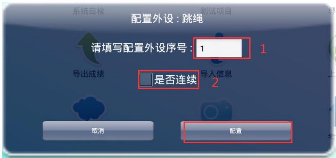
外设序号，是主机与测试附件的开始编号，默认从 1 开始，如果有多个附件，如跳绳有 20 个，则默认开始外设序号填写 1，第二个跳绳填写 2 以此类推。是否连续是为了方便多个附件时，为了不手工累加外设序号，而是自动累加。填写完外设序号后，点击配置按钮，之后打开附件开关，如果主机与附件联通，则提示配置成功。如果没有反应，请再次关闭附件并打开，重复几次可顺利配置成功。后会自动给出自检情况，如下图所示：
