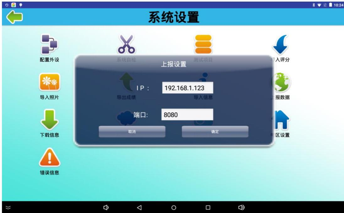
填写云平台或相关软件，所在 IP 及监听的端口，点击确定，设置成功。
