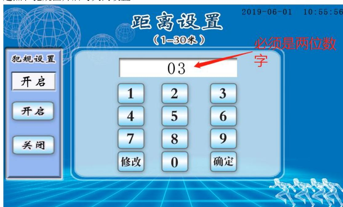
**注意：**设置距离是指投掷起点至测试杆“0”点距离，即起投点到测试杆起点位置。犯规设置状态为开启时，主机首先检测犯规装置，正常后可以测试，踩线播报犯规并且无成绩。犯规设置关闭时，主机检测测试杆，不存在主机播报犯规问题。
